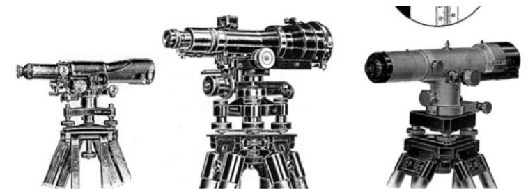
Niveles de alta precisión, de izquierda a derecha, Kern, Wild y Zeiss, retículo de cuña y nivel de coincidencia (h. 1930).
